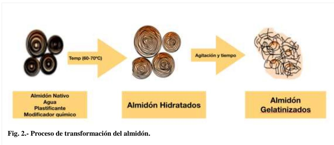
Fig. 2.- Proceso de transformación del almidón.
