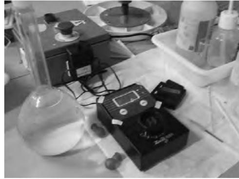
**Figura 2. Colorímetro usado en el proyecto**
